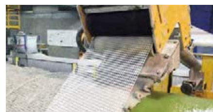
ZMU-Beschichtung im Extrusionsverfahren
