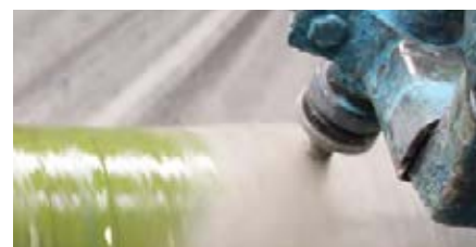
ZMU-Beschichtung im Spritzverfahren
